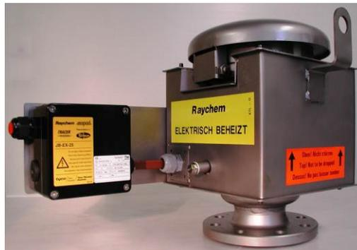
Fig.21: KITO® Soupape de surpression/dépression anti-déflagration et résistant au brûlage continu avec chauffage électrique
